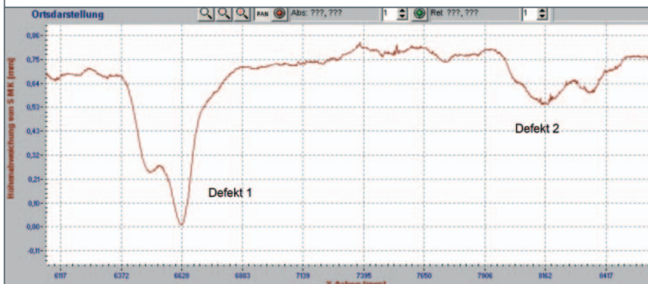
BILD 7: Rundlaufabweichungen des rechten Rades, in der Werkstatt mit dem INNOtec-Messsystem RUDI gemessen
