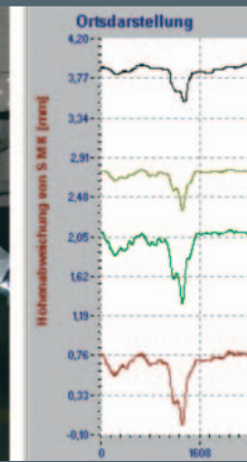
BILD 11: links: Rundlaufdiagnosesystem RUDI zur gleichzeitigen Erfassung von 4 Messspuren, rechts: Messschriebe der 4 Taster für einen Radumfang
